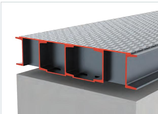
Платформы весов «АВИОН» выполнены в виде пятибалочной ортотропной конструкции с дополнительным усилением за счет нижнего металлического листа. Толщина верхнего настила 10 мм. Поэтому Ваши весы выдержат нагрузки, вызванные ежедневными проездами тяжелых грузовиков, без прогибов и деформаций.
